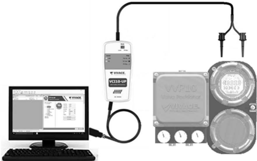
Figura 3.4 - Esquema de conexión de interfaz VCI10-UP al VVP10-P.
